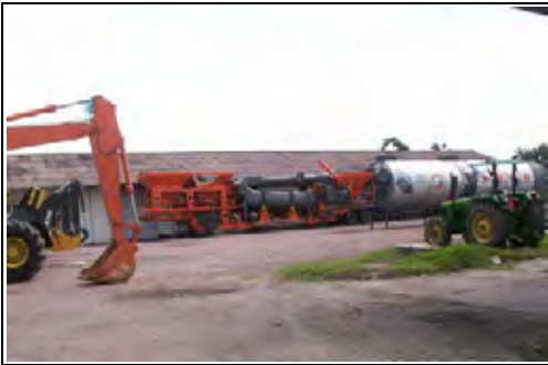
道路公社の機械局にストックされている移動式アスファルトプラント(地方支局に回される)
