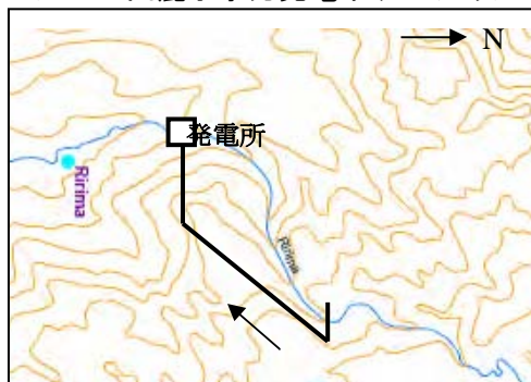
位置図 (計画: 落差 183 m・出力 2.5 MW)
