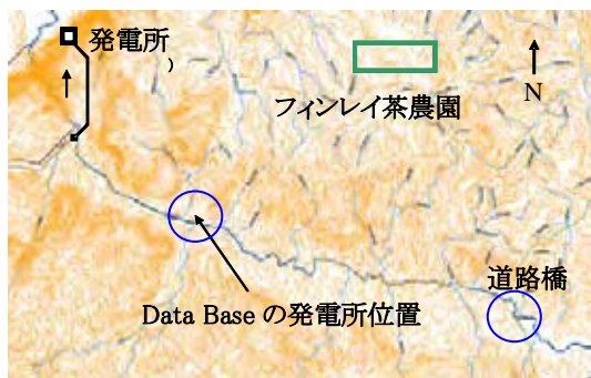
位置図(計画: 落差 385 m, 出力 20 MW)
