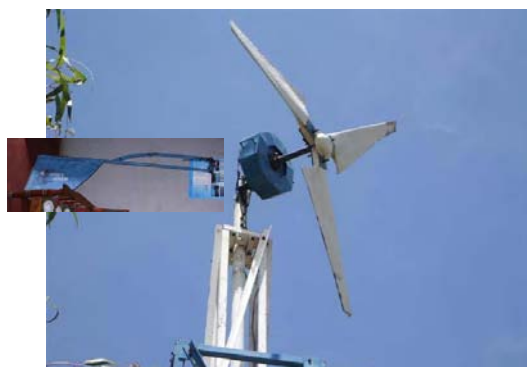
風力発電機 (2.5 kW・尾翼故障中)
