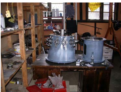
水車(流量 1.2 m 3 /s, 落差 11~22m, 100 kW)
