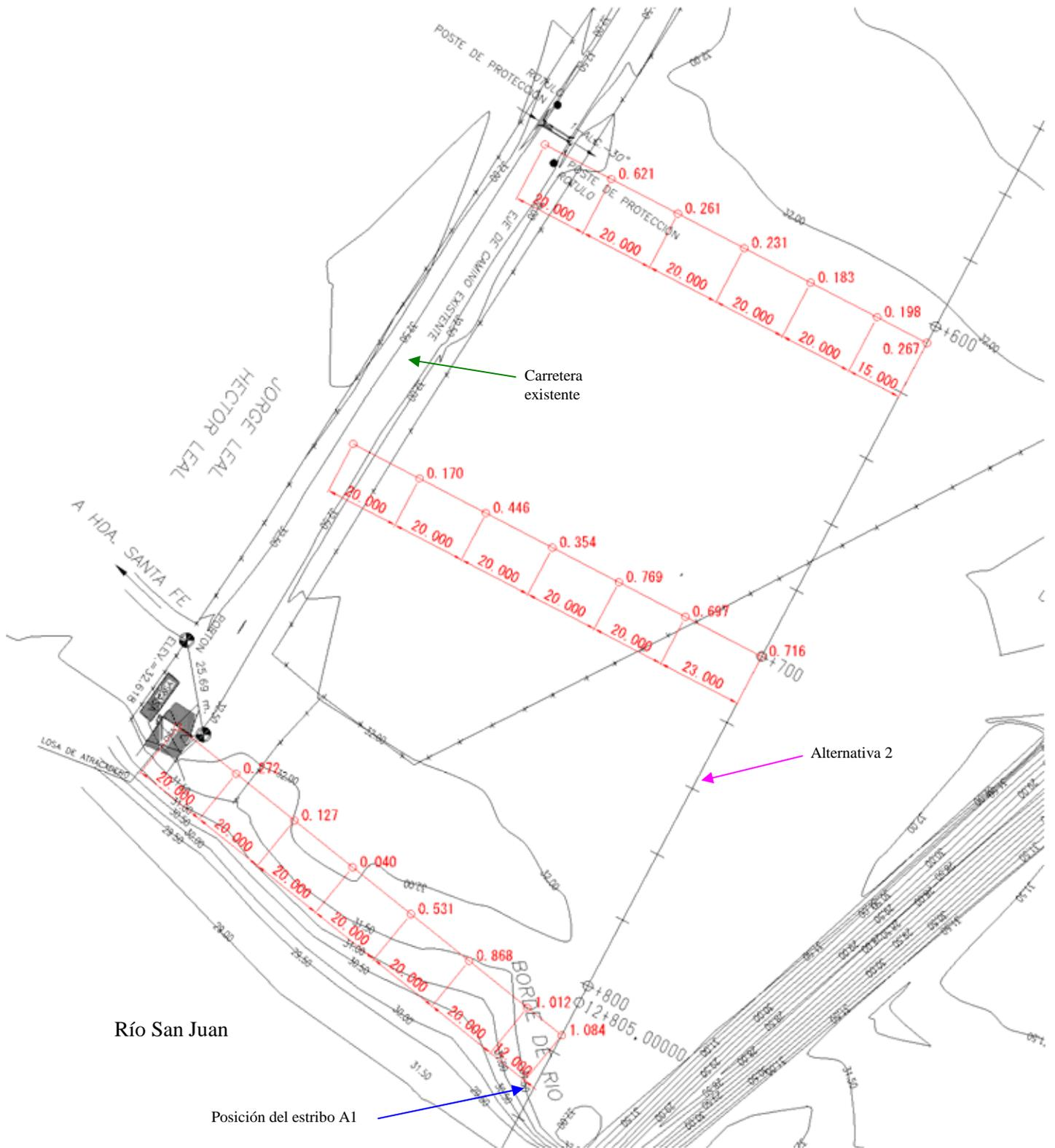
Figura 2-2-8 Plano batimétrico alrededor del estribo A1
