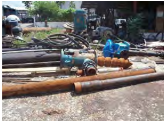
焼きついて使用できなくなったポンプ(東部統括事業部)
