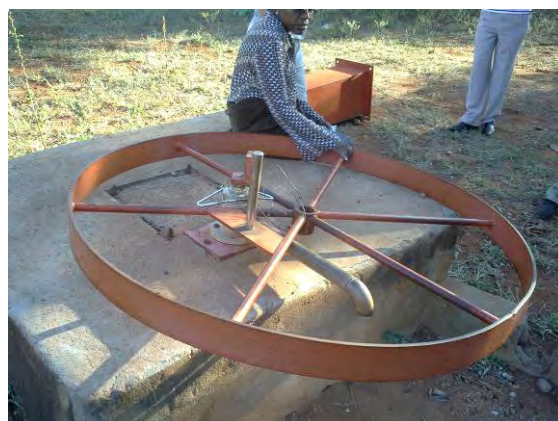
写真 18 (2009/04/16) 撮影 ボランテ式ポンプのパーツ。水委員会がスペアパーツを入手出来ず、故障したまま放置されている。
