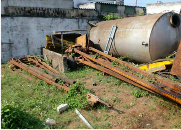
写真 19 (2009/4/20) 撮影 EPAR-Maputo 敷地内に置かれているパーカッション移動式掘削機のマストおよび給水タンク。現在は稼動していない。
