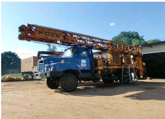
写真9 (2009/04/15) 撮影 EPAR-Gaza が所有する日本の無償資金協力「ガザ州村落飲料水供給計画」(1996 年) で供与された井戸掘削機。現在も稼働しているが老朽化がすすんでいる。
