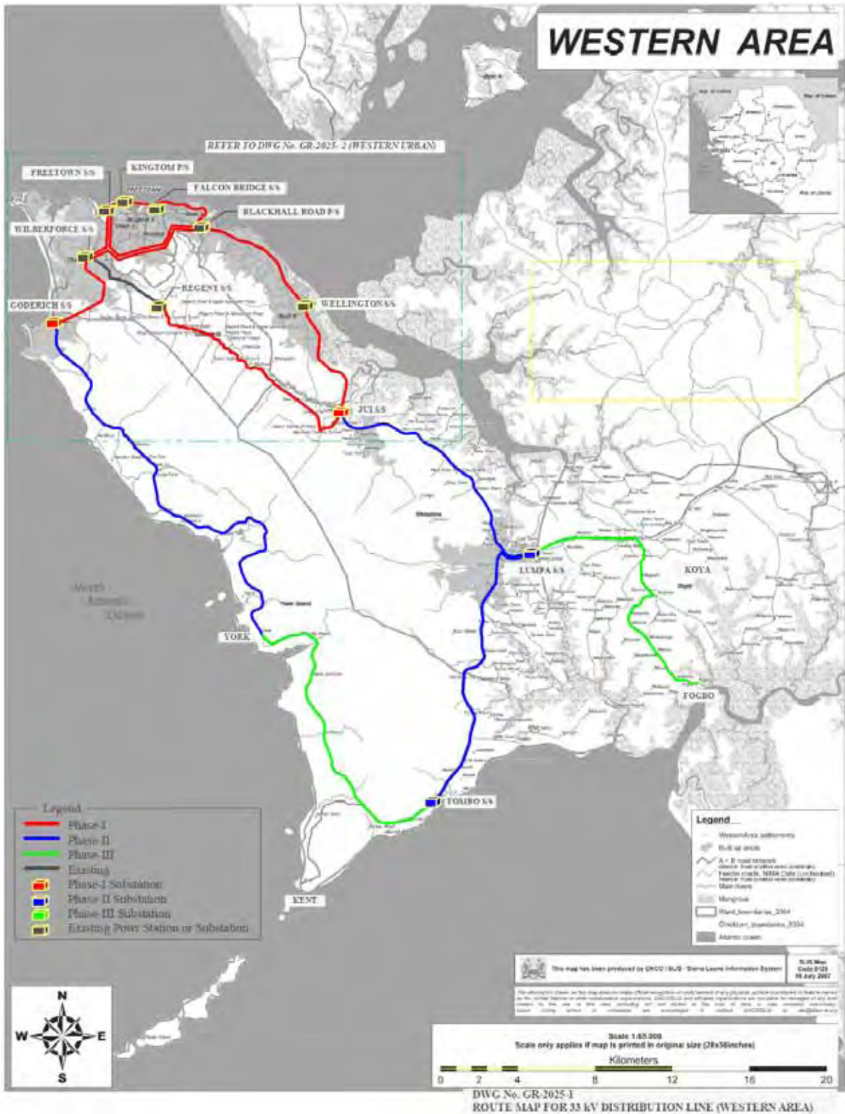
図 6.3-3 33 kV 配電線のルート図 (ウェスタンエリア:2025 年)
