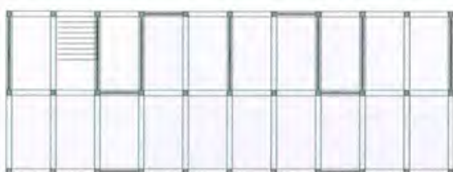
Рис. 6 Расположение несущих ж/б стен для сейсмоусиления (случай №1)
