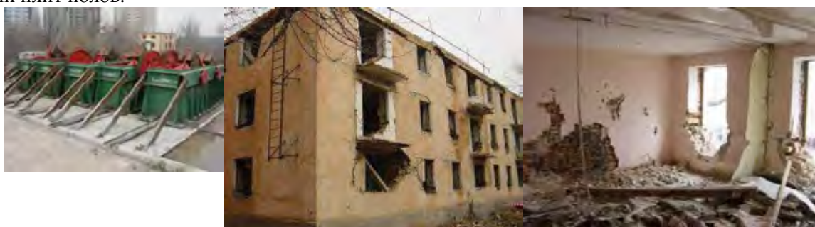
а) Вибромашина на крыше дома в) Внешний вид дома с) Разрушения внутри дома
