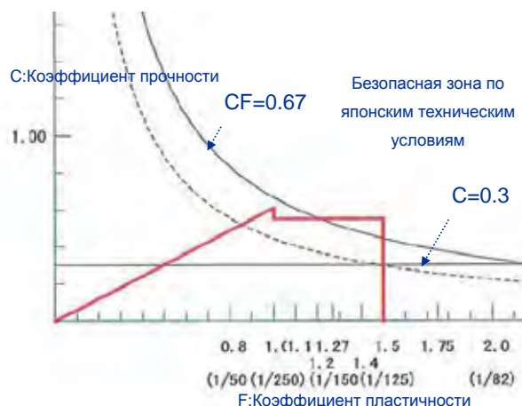
Рис. 6.1.11 Связь между коэффициентом прочности и коэффициентом пластичности крупнопанельной конструкции
