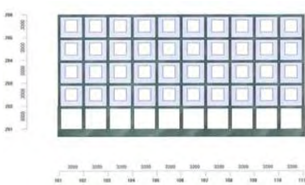
図 6.1.15 ソフト階の構造軸組図
