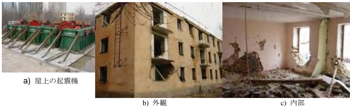
図 6.1.20 レンガ組積造の震動実験 (KazNIISSA)
