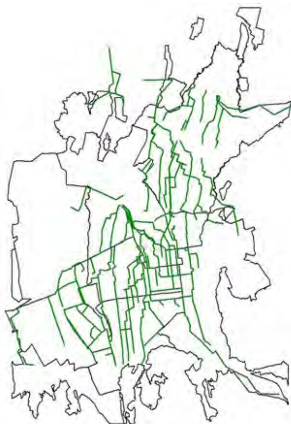
図 2.6.2 下水道の主要管路網図
