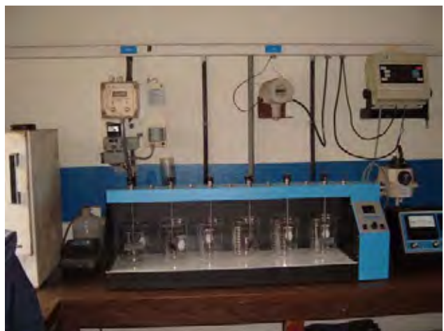
Mona 浄水場 水質試験器 ジャーテスター: あまり使われていないようである。
