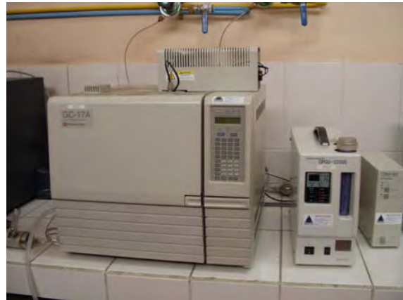
ガスクロマトグラフ装置 環境水基準項目の分析に使用。
