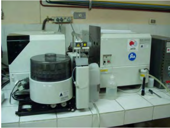
原子吸光度計（炭素炉加熱方式） バーナー式とともに使用頻度が高い
