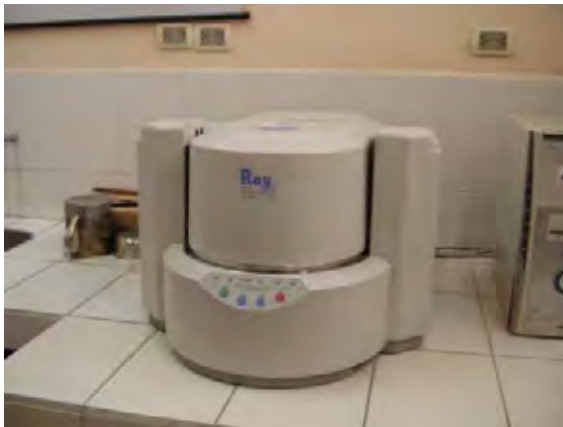
蛍光X線分析装置 液体・固体の非破壊分析が可能（定 性分析・半定量分析に使用）
