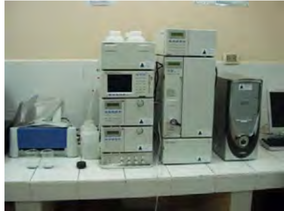
イオンクロマトグラフ装置 接液部の劣化により、休止中。 スペアパーツの交換が必要。4月に 交換の予定。
