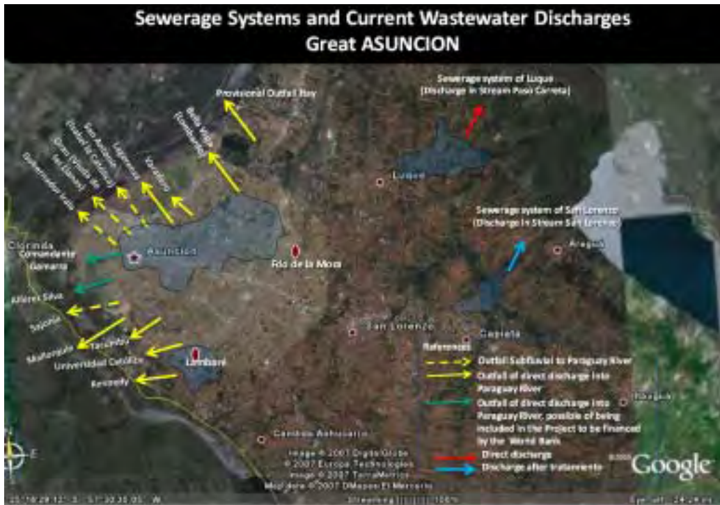
Figura 5.21 Áreas de Servicio de Alcantarillado en el Área Metropolitana de Asunción y rutas de descarga a los ríos
