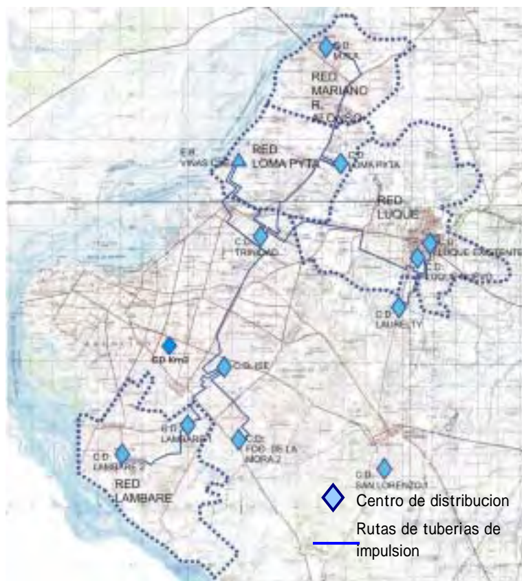
Figura 5.18 Centros de Distribución y rutas de tuberías de impulsión construidos por el Proyecto de Mejoramiento del Servicio de Agua Potable en Asunción
