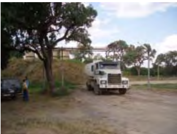
Ciudad de Filadelfia, departamento de Boquerón zor central del Chaco en la región occidente Pozo utilizado como fuente, propiedad de las cooperativas menonitas a 25 km de la ciudad de Filadelfia. De los 12 pozos, utilizan 10. Como no se cuenta con cañería de bombeo, se realiza el transporte con camión sistema de 33m 3 de capacidad por camión.
