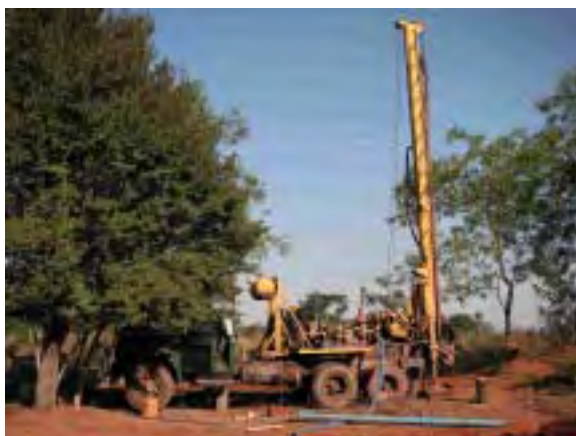
Perforadora de pozo de la empresa privada de Carl Antonio López km 15, departamento de Concepción Comunidad rural sujeto del programa de préstamo "Programa de fortalecimiento del sector agropecuario II". Perforadora de pozo tipo rotativo de la empresa privada, consignado por SENSA. Estaba en la etapa de ajuste, antes de la perforación.
