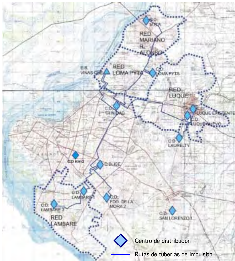
Figura 5.20 Centros de Distribución y rutas de tuberías de impulsión construidos por el Proyecto de Mejoramiento del Servicio de Agua Potable en Asunción
