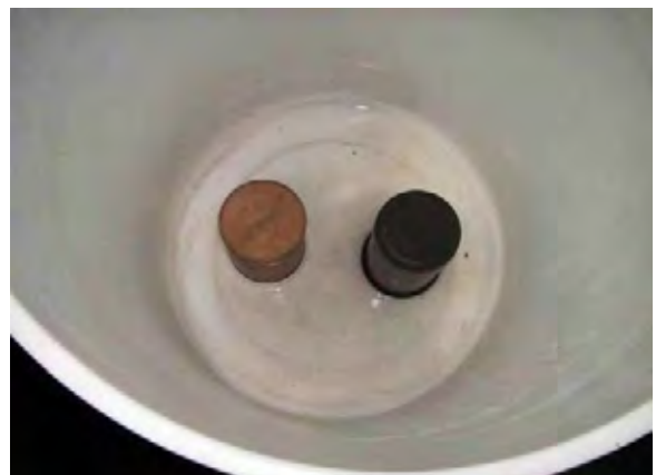
簡易浄水器 簡易浄水器内部 2つのフィルターを通してろ過される
