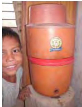
ホケロン県(西部) Santa Helena 簡易浄水器 小学校に設置された簡易浄水器。内部が2層構造となっており、上部から下部に至る間にセラミック製のフィルターが2つ付いており、上部に溜まった水がセラミックを通過することでろ過させる。SENASAにより各戸に配布されているが、半数程度しか利用していないとの話であった。
