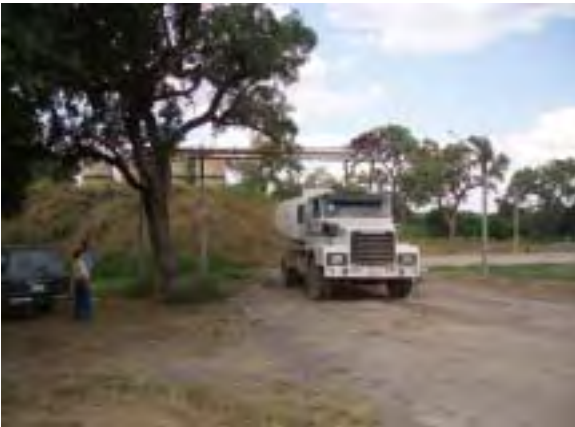
西部Central Chaco ホケロン県 Filadelfia市 filadelfia市から約25km、メノータ組合が所有水井水源地。12井所有。うち、10井使用。送水管はなく、給水車で運送する。1台あたり33m3を搬送。
