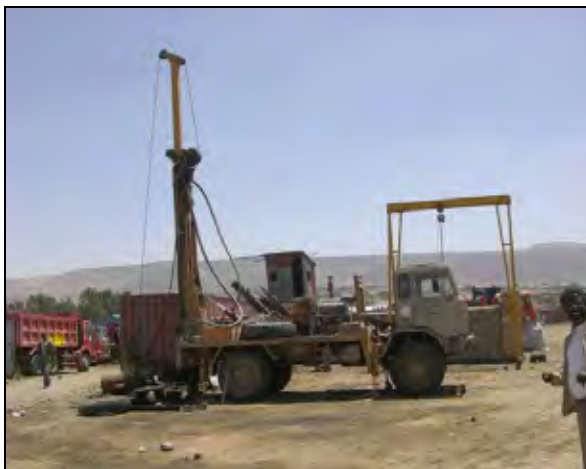
写真-1 ティグライ州給水施設建設公社(TWWCE) ワークショップ・資材置き場で整備中の井戸掘削 リグ(Atlas Copco 製 150m 級)
