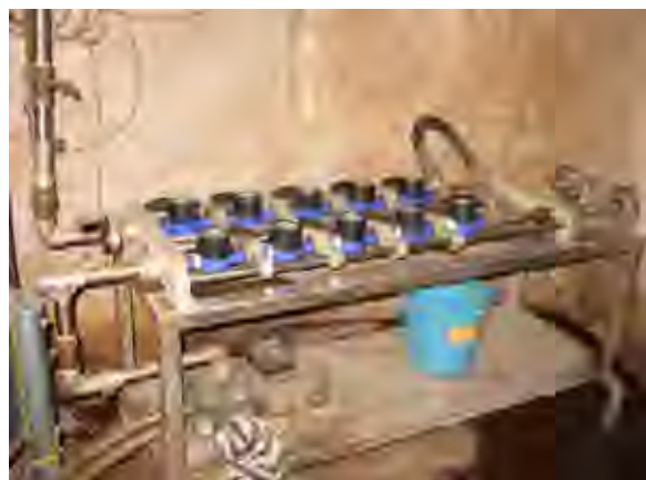
ロケット2（支局2）内のワークショップにあるメーターテストベンチ。1998年に中央政府（PU）から供与。
