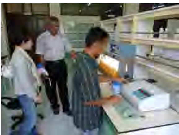
（上）ソンバ・オブ浄水場のラボ。2 時間おきにジャーテストを行い、薬注量を調節している。水質分析機器は揃っている。
