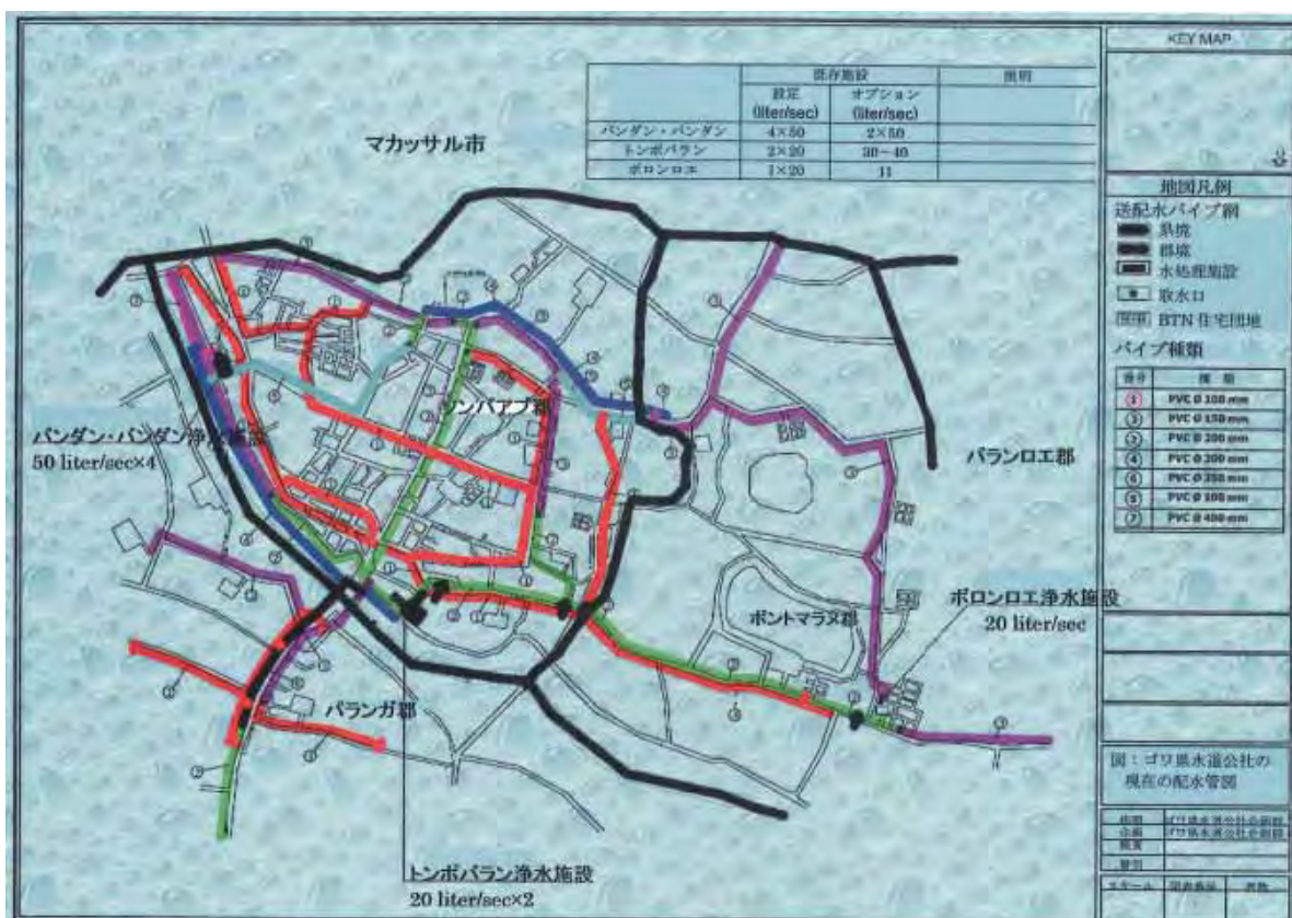
図 4.5.3 給水区域中心部の配水管網図
