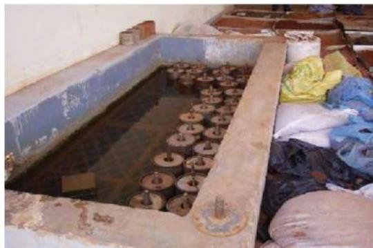
写真 3-5-2 MOWT の中央材料試験室での CBR 試験のために水槽内に供試体を水浸
