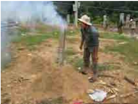
3. Khi quá trình đốt thành than bắt đầu thì sẽ có khói trắng thoát ra ngoài.
