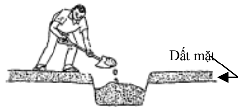
Hình-11 Lắp đất vào hố
