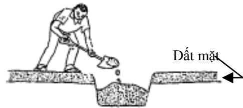
Hình-11 Lắp đất vào hố
