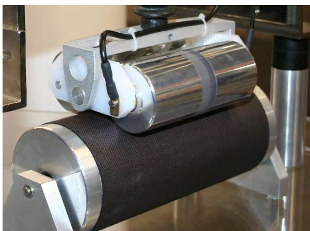
図 3.3.2-11 部分接触式水分センサー
