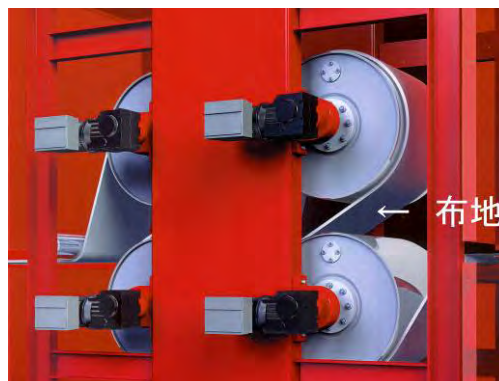
図 3.3.2-7 シリンダー乾燥装置
