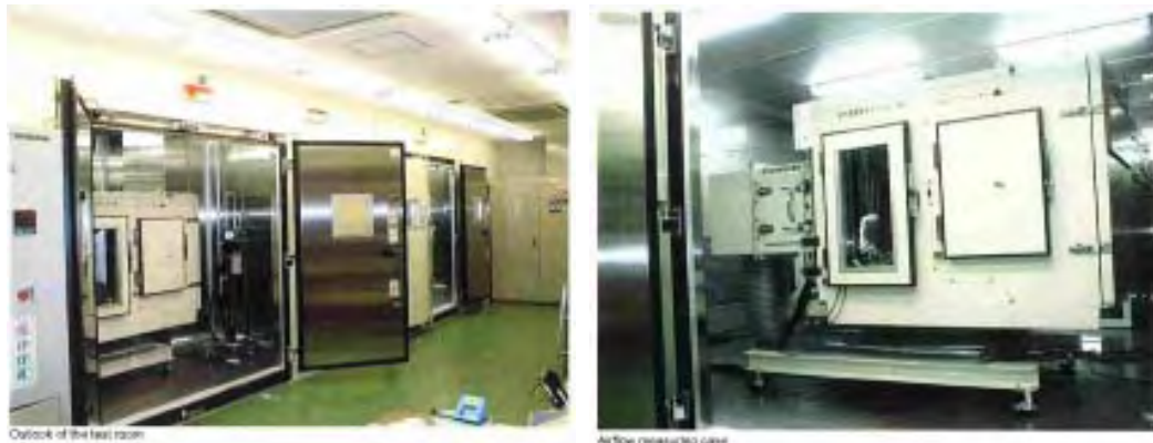
図 4.2.2-2 空気エンタルピー試験装置 (㈱大西熱学パンフレットより)
