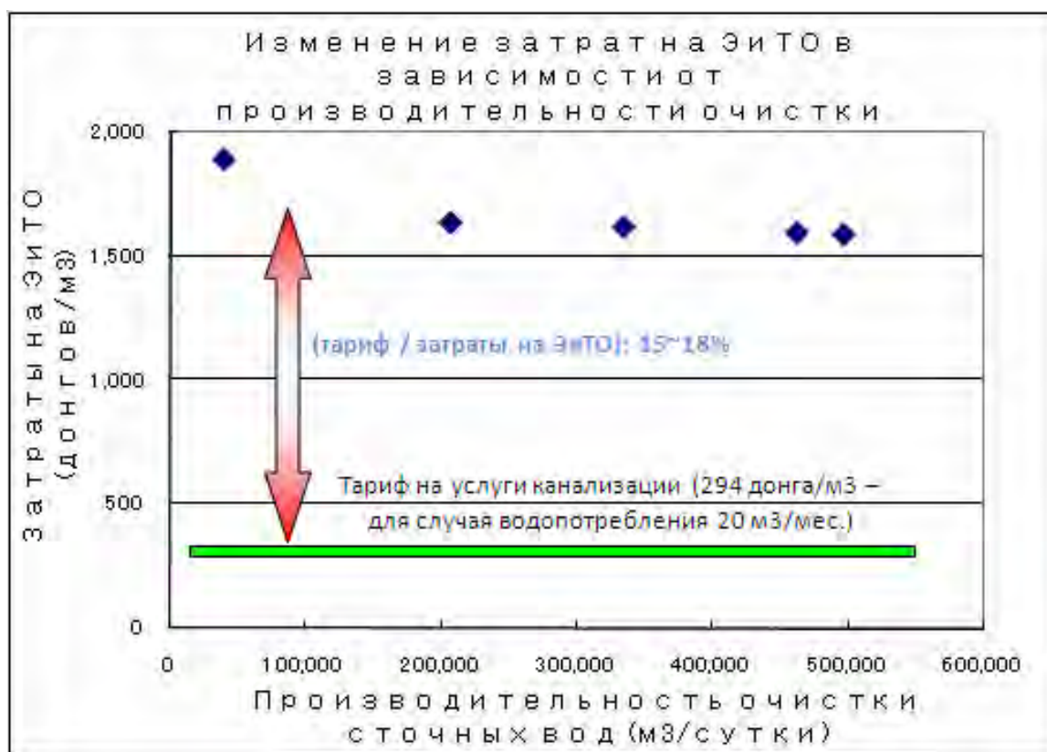
Рис. 3.2.11 Этапы оснащения системы канализации и связь между затратами на ЭИТО и уровнем тарифа (г. Ханой)
