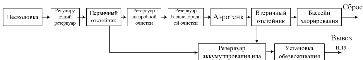
Рис. 3.1.9 Блок-схема технологического процесса очистки на КОС Kim Lien
