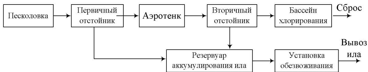
Рис. 3.1.6 Блок-схема технологического процесса очистки на КОС Сев. Thang Long
