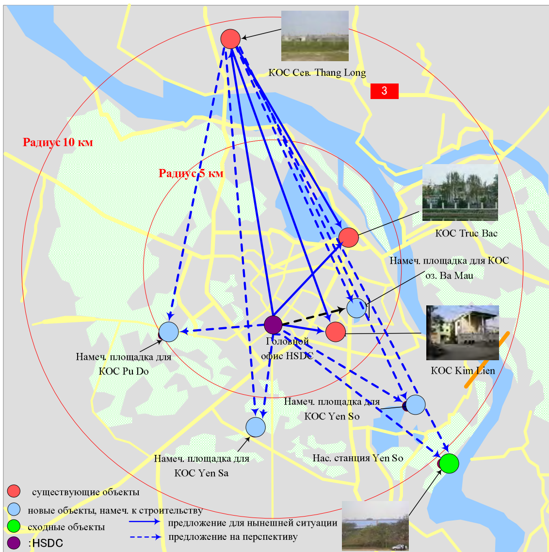
Рис. 3.2.1 Концептуальная схема централизованной системы диспетчерского контроля КОС г. Ханоя
