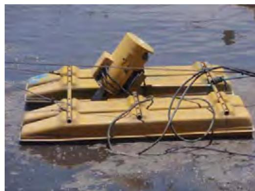
Рис. 2.1.42 Аэратор с наклонным винтом
