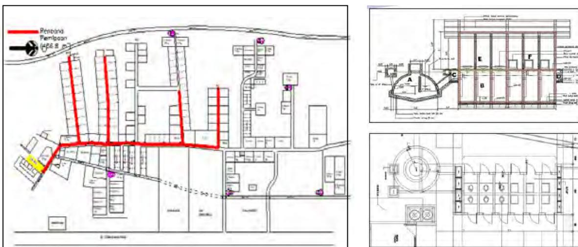
Рис. 2.2.2 Расположение объектов САНИМАС (левый рисунок) и конструкция очистного сооружения (правый рисунок)
