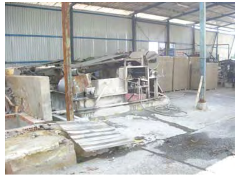
図 3.2.9 ペーパー・スラッジリサイクル設備
