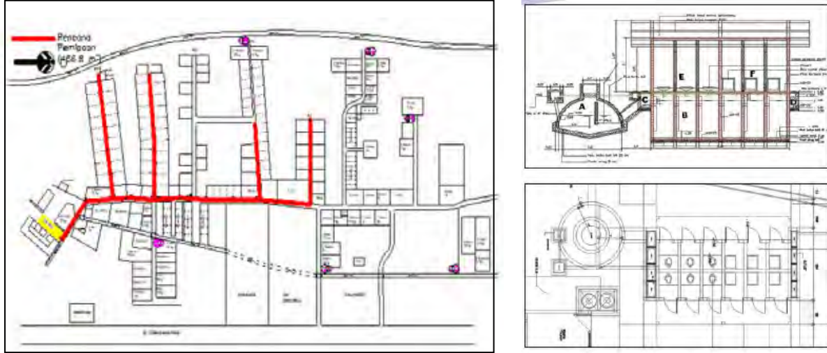
図 2.2.2 SANIMAS の施設配置(左図)と処理施設の構造(右図)
