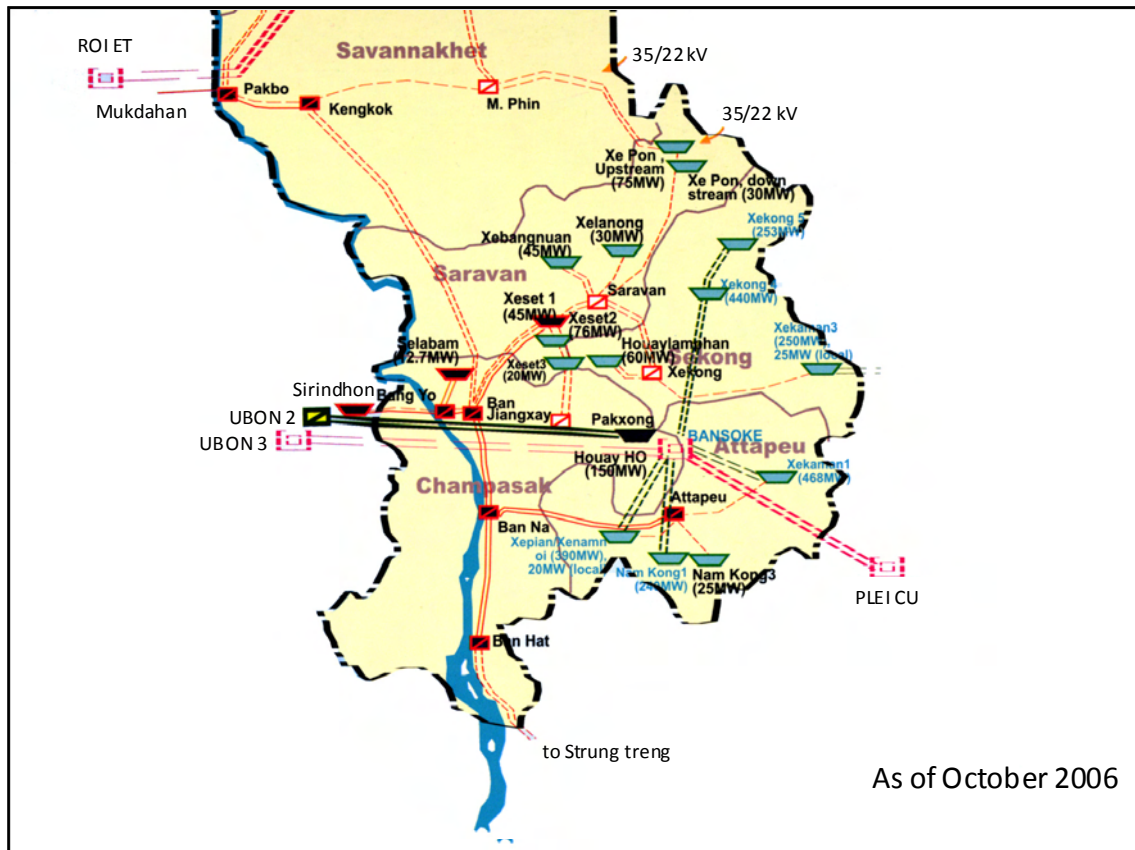
図 4.3 ラオス南部地域の送電系統
