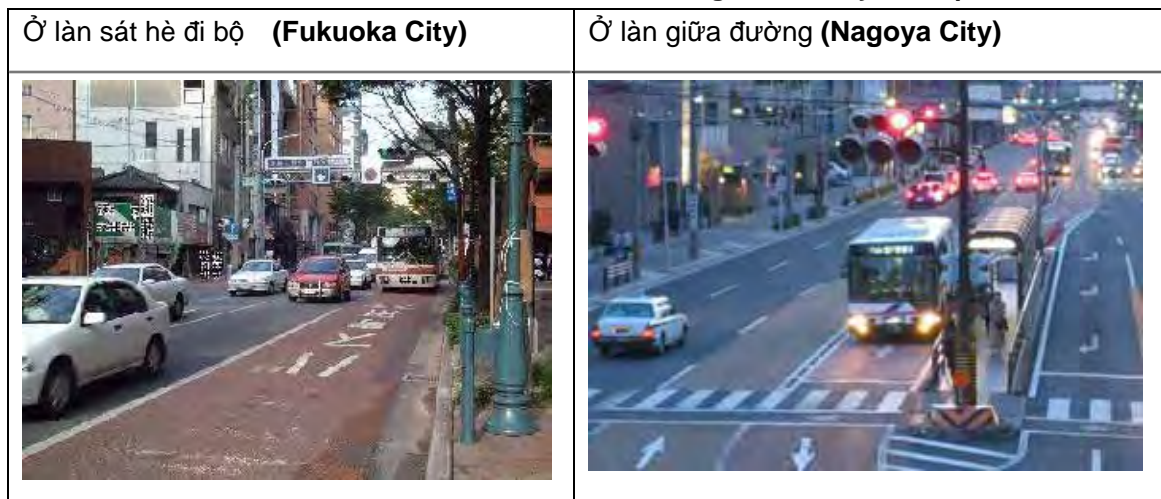
Hình 3.10.5 Mô hình bố trí làn dành riêng cho xe buýt ở Nhật
