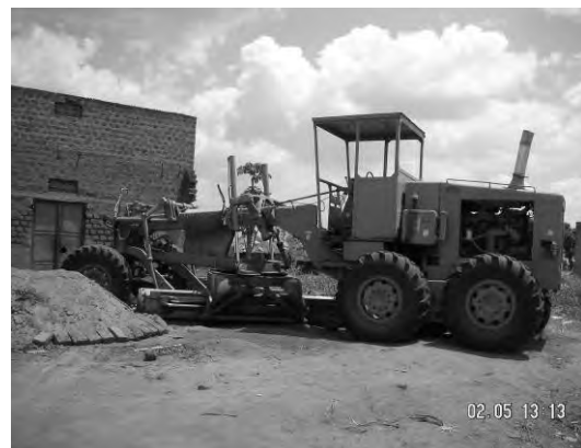
Periodic Maintenance が進行中の国道 Kitgum-Lira 間の Pajule 近く。【右】工事に使用されている建設機械 (グレーダー)。UNRA-Kitgum によると、Periodic Maintenance 工事の人力コンポーネントは 15% 以下。Culvert installation (600mm が 3 本、900mm が 8 本)、Gravel 仕上げ (100mm 厚) で構成される。Pader 県
