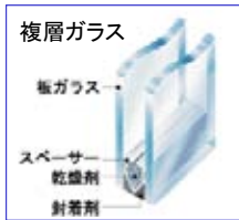
高断熱窓への取り替え
