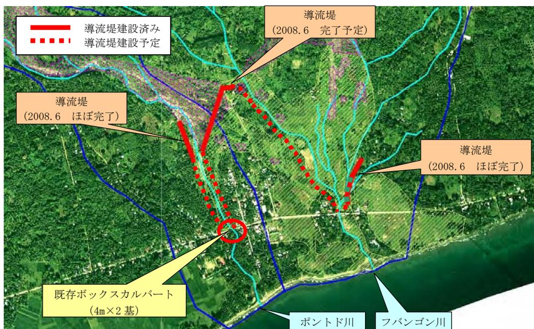
図 R 3-2.4 DPWH-DEO によるトレーニングダイク(導流堤)計画
