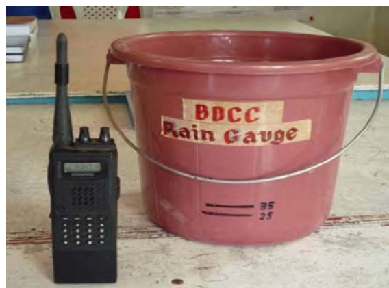
写真-6：我が国の災害ソフト対策支援により供与された簡易雨量計と緊急連絡機器
