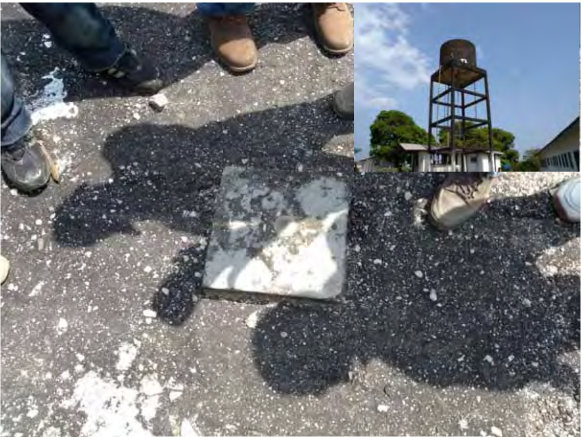
フリーポート内、給水等直下の BM (水準点)
