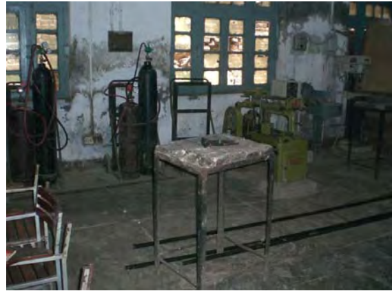
機械学科 ガス溶接ブース（奥左側にガス溶接機、右奥は電動鋸盤）
