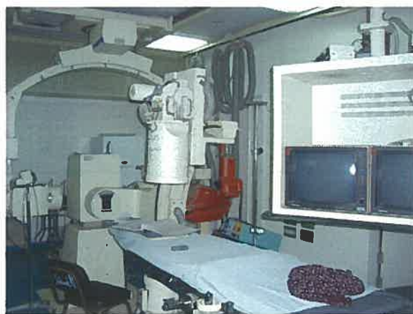
心臓カテーテル検査室に設置されている X 線血管造影装置。現在故障中により使用停止
