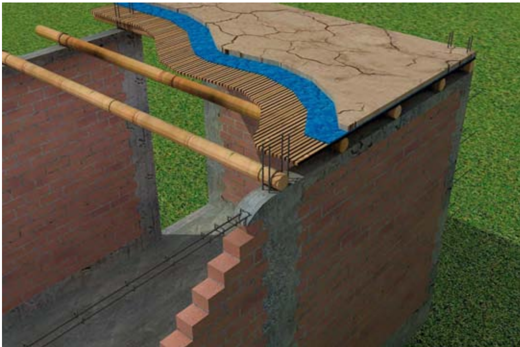
Imagen del proceso constructivo del techo de caña
