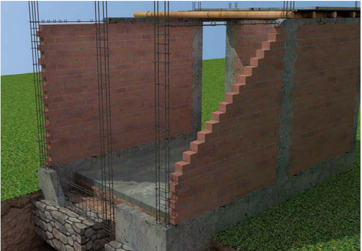
Imagen del proceso constructivo para una vivienda más segura
