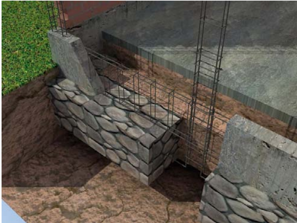
Imagen del proceso constructivo de la cimentación y el sobrecimiento
