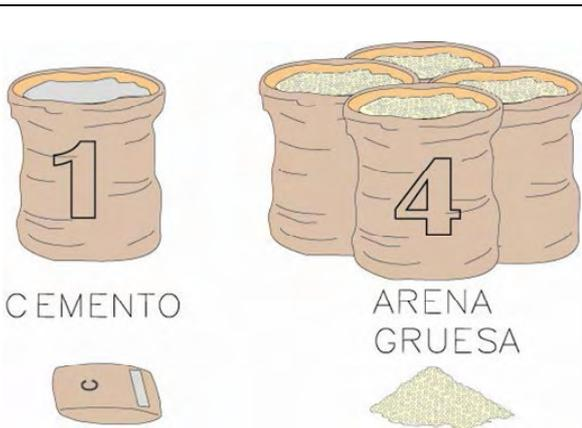
**13.-** La dosis para el mortero se obtendrá de mezclar (1:4) 1 bolsa de cemento + 4 bolsas de arena.
