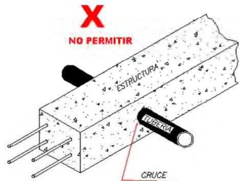
**18.-** Verificar que los tubos de agua, desagüe y eléctricos estén ubicados en los muros y no en las vigas y/o columnas.
