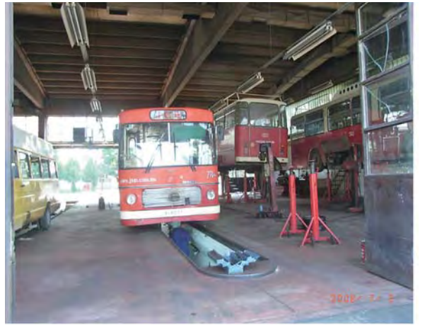
図 16 足回り整備場の3S ・作業スペースが広く、安全面も向上
