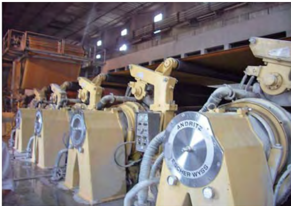
図4 抄紙ライン オーストリア/アンドリッチ社製
