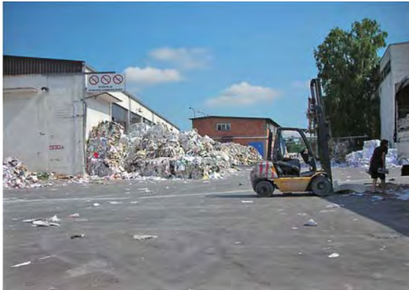
図2 原料古紙ヤード ：荷姿雑多、各種の異物混入が多い
