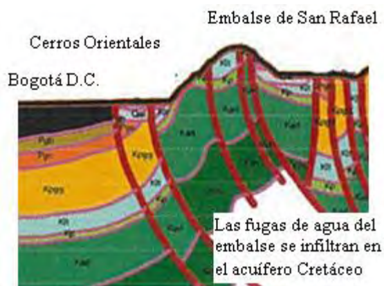
Figura-2.1- 40 Fugas de Agua del Embalse de San Rafael
