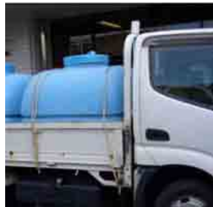
図3.3-59 車載用給水タンクの例
