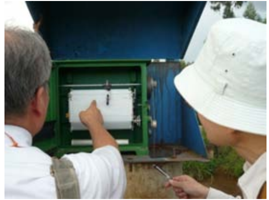
写-24 : Simu 川測水所 (フロート式自記水位記録計: ドイツ製。毎月 1 回の流量観測を目標にしているが予算の関係でできないことがある)
