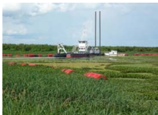
写-65 : Kikoge 浚渫基地(Sudd と呼ばれる草でできた浮島がチヨガ湖の出口を閉塞するため 2001 年からエジプトによりチヨガ湖の出口の浚渫が開始され、毎年・一定期間、浚渫が実施されている。この付近でも水草が繁茂し、水面が僅かに見える程度)
