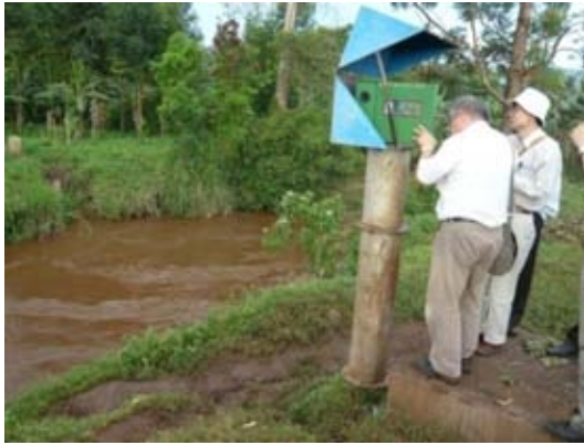
写-24 : Simu 川測水所 (フロート式自記水位記録計: ドイツ製。毎月 1 回の流量観測を目標にしているが予算の関係でできないことがある)
