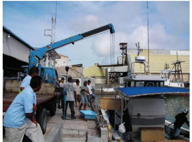
写真-6 満載したクーラーボックスの重量は 100kg を超えるため、移動にクレーントラックが必要なことも作業効率を落とす要因となっている。
