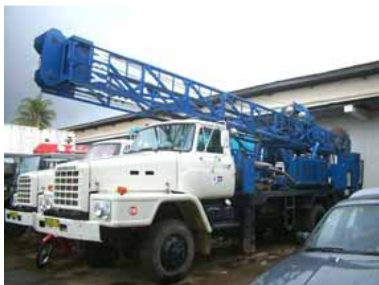
写真-12：掘削リグ 無償資金協力「プノンペン市周辺村落給水計画」（2003～2004 年度）で供与された掘削リグ。本計画でもカンボジア政府より貸与予定である。
