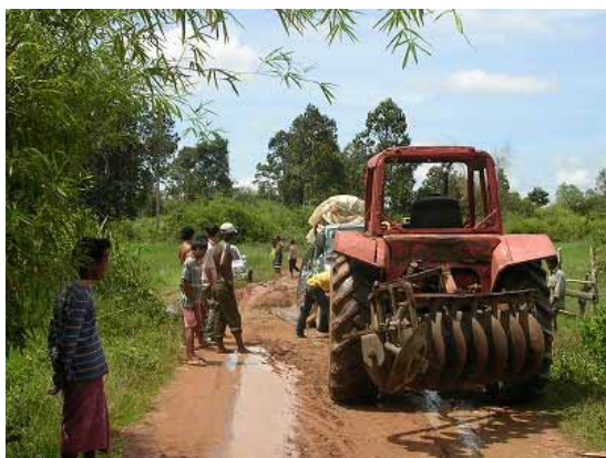
写真-11：アクセス状況 国道 7 号線から村落に向かう枝線道路でスタックするワゴン車を農業用トラクターで牽引している様子。路盤は、ラテライトで構成されているため、雨期になると表層がぬかるみ、4WD 車ですら通行が困難となる。
