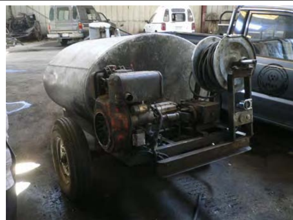
写真 B-6 DSDC が自作した小型洗浄車 ( DSDC にて )
