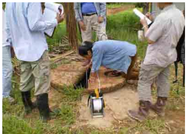
Departamento de Pando 034 Avaroa Medicion de nivel de agua en un pozo redondo
