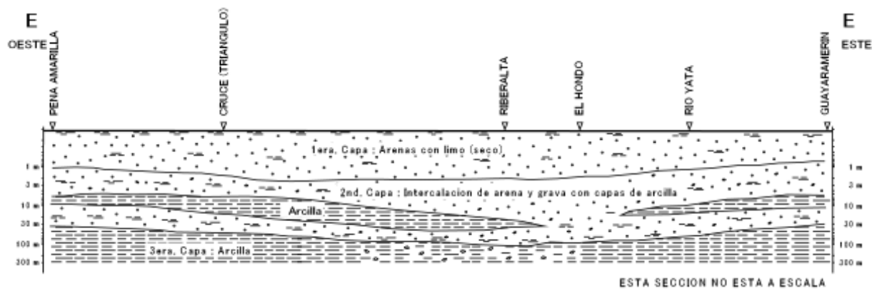
Figura 5.2.6 SECCION TRANSVERSAL DE ESTRUCTURA GEOLOGIA EN AREA "PENA AMARILA - RIBERALTA - GUAYARAMERIN"
